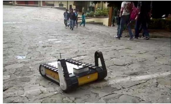
d) el sistema de comunicación transmitió sin pérdida de información las instrucciones enviadas por el usuario al robot móvil, en un ambiente cerrado con obstáculos de paredes, muebles y personas del entorno, en un radio de 10 m.
