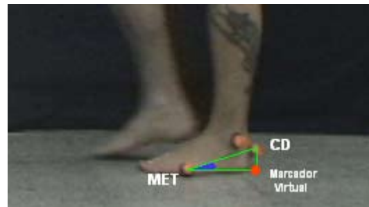
Figura 11. Marcador virtual usado en el modelo cinemático del tobillo.
