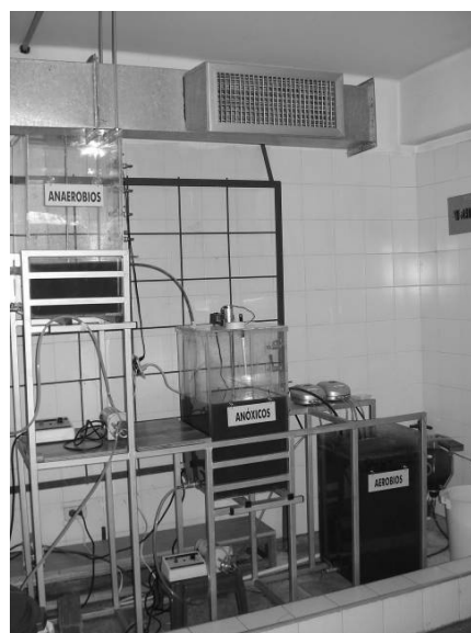
Figura 1. Montaje experimental (proceso A2/O) empleado durante la fase de investigación
