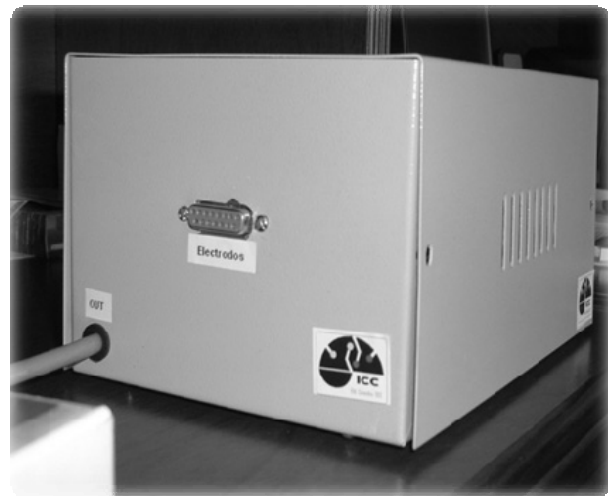
Figura 3. Electroencefalógrafo construido para la interfaz cerebro-computador
